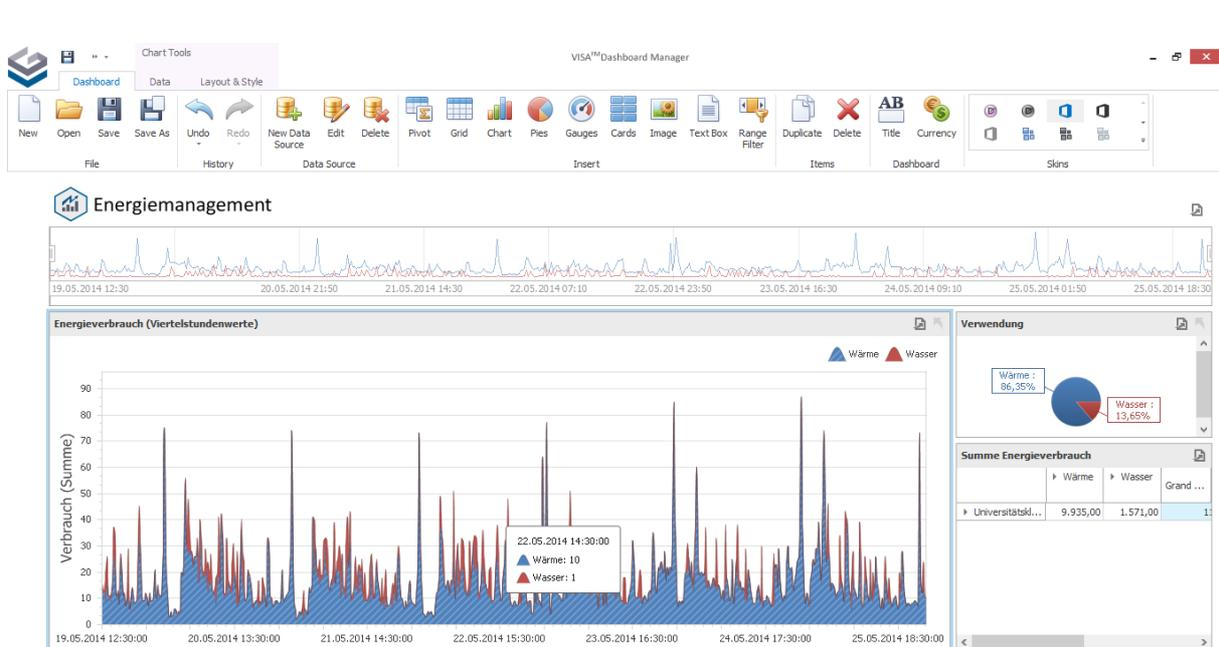
7 Tage Verlauf des Wärme- und Wasserverbrauchs im 15 Minuten Intervall
